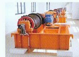
2x630kN新型闭式卷扬启闭机 应用于广东清远水利枢纽工程上
