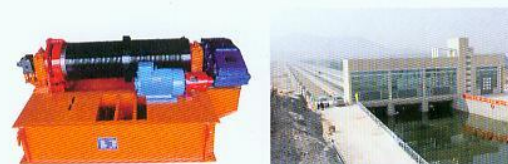
500kN新型闭式卷扬启闭机应用于南水北调中线穿黄工程上
